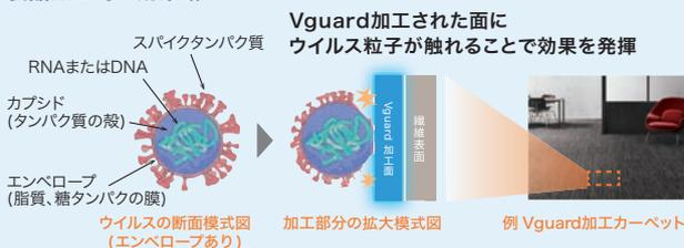
Vguard加工面にウイルス粒子が触れることで表面の脂質、タンパク質に作用し破壊
